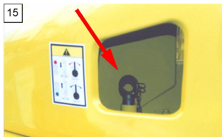
Рисунок 15. Шкворень блокировки поворота опорно-поворотного устройства.
